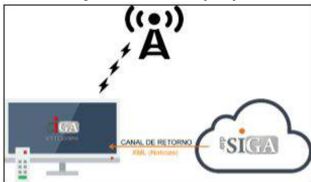
Figura 2 – Funcionamento do protótipo
